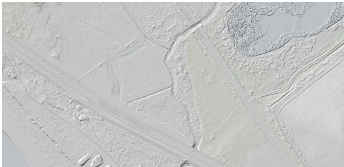
Figur 1) DHM/Havstigning ses her visualiseret som skyggekort. Øverst i billede kan man se udkæring af en bro. Nederst i billede kan man se en sluse der er lukket.
