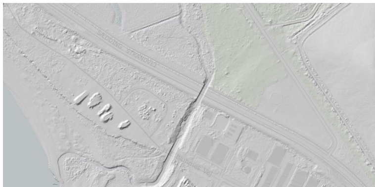
Figur 1) DHM/Nedbør visualiseret som skygge kort. I midten af billede ser man udskæring af en bro som muliggør at overfladevandets flow og samlingssteder kan simuleres korrekt.
