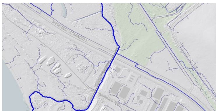
Figur 3) Flowsimulering for et givet oplandsareal i meter 2 . Til grund for denne analyse ligger DHM/Nedbør. Hvis ikke broen midt i billedet var fjernet fra DHM/Nedbør, ville den simulerede vandstrømning - i modsætning til den naturlige strømning - stoppe ved underføringen under Sædding Strandvej. Dermed ville DHM/Bluespot_ekstremregn vise et andet resultat.
